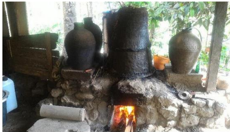
Gambar 3. Alat Penyulingan Arak Tradisional
