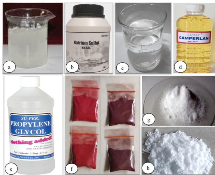
Gambar 2. Bahan yang Diperlukan dalam Pembuatan Sabun Cair Berbahan Minyak Goreng Bekas. a. Texapon; b. \text{NaSO}_4 ; c. Akuades; d. Camperlan; e. Propylene Glycol; f. Pewarna Pakaian/Makanan; g. EDTA/Titriplex III; dan h. \text{NaCl}
