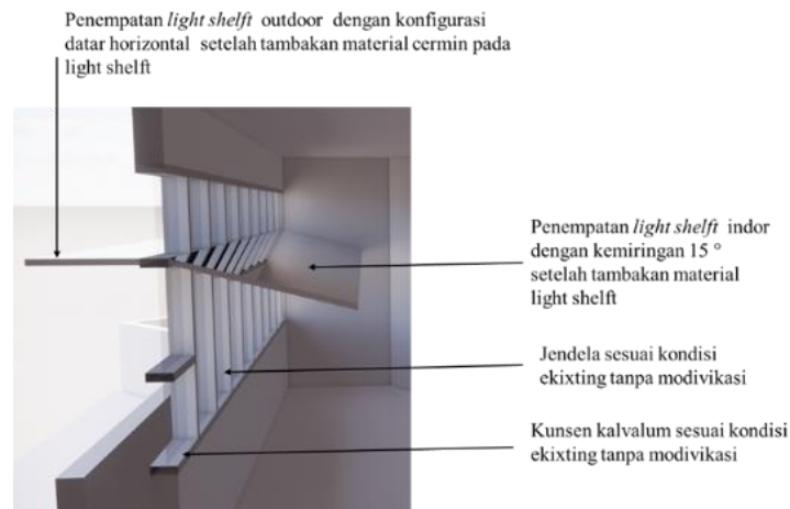
Gambar 8. detail model 3d setelah tambahkan material metal
