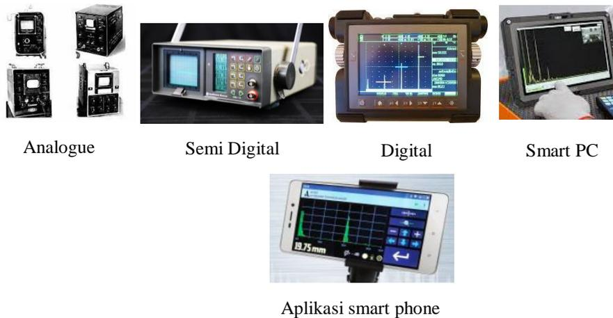
Gambar 7. Perkembangan alat Ultrasonic Flaw Detector
