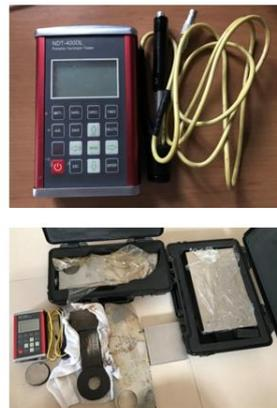
Gambar 11. Alat uji kekerasan
