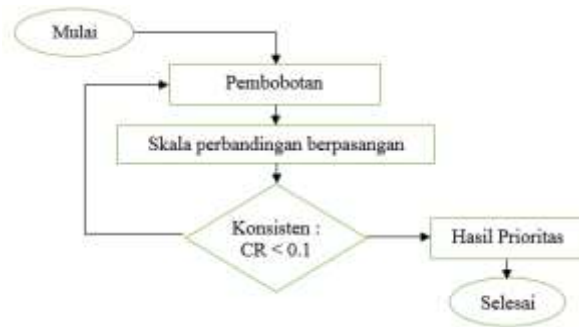
Gambar 3. Flow Chart Pengujian Konsistensi
