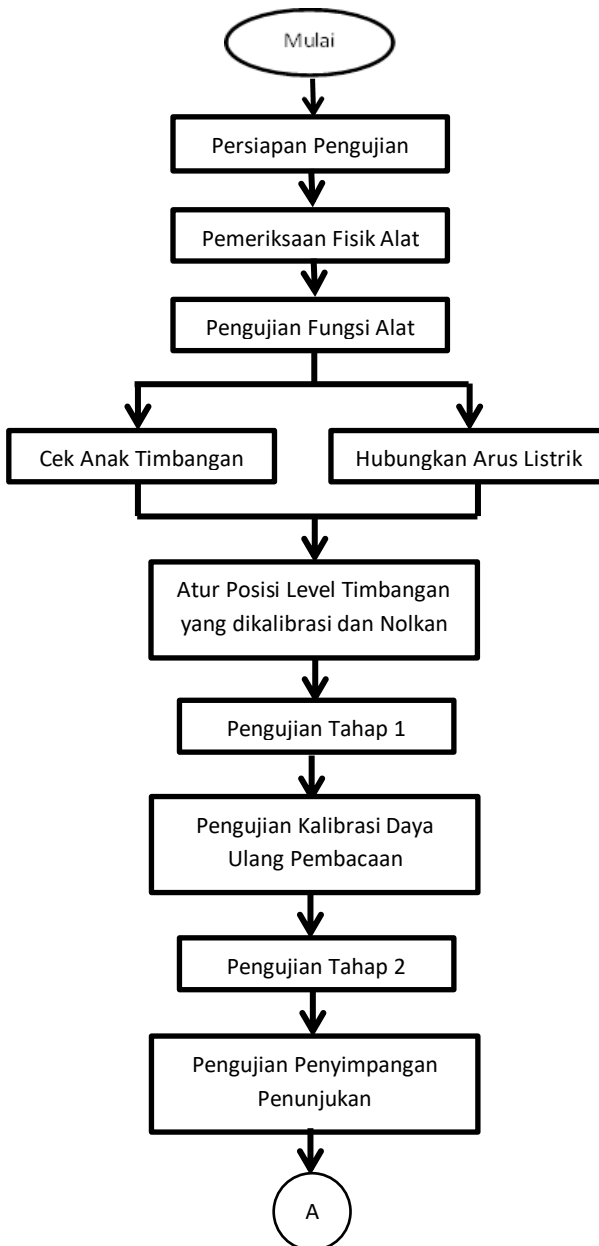
Gambar 4. Diagram Alir Kalibrasi
