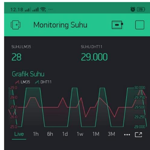
**Gambar 12. Pengukuran Suhu pada Ruang Dosen menggunakan Blynk**
