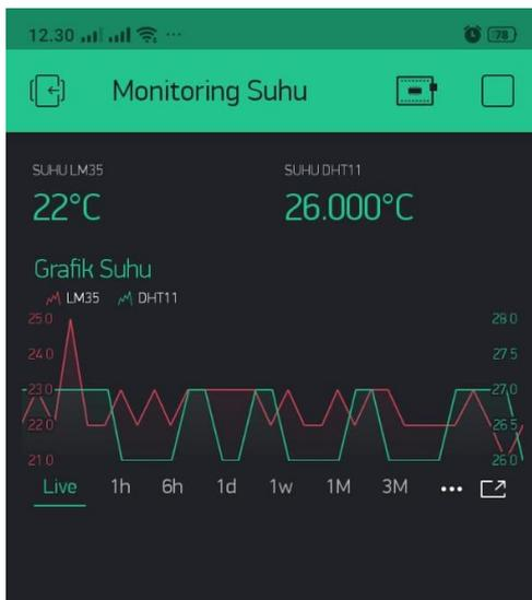
**Gambar 14. Pengukuran Suhu pada Ruang Server menggunakan Blynk**
