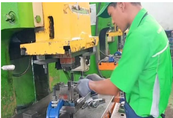
Gambar 2. Proses Pierching pada Mesin Stamping
