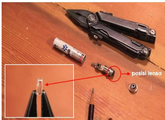
**Gambar 3. Lensa dari laser *pointer*.**
