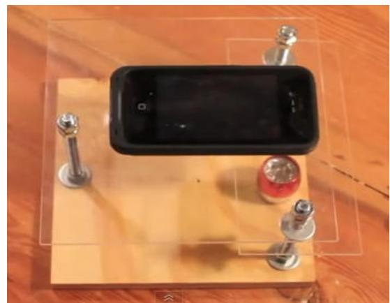
**Gambar 5. Posisi lensa *smartphone* tepat di atas lensa laser *pointer***
