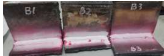
Gambar 4. Hasil Pengelasan sample B1, B2,B3 dengan Uji Pentrant Sumber: Peneliti (2021)
