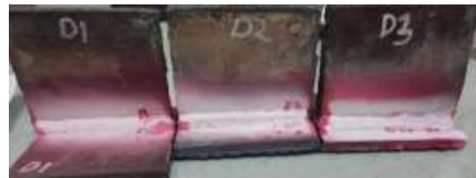
Gambar 6. Hasil Pengelasan sample D1, D2,D3 dengan Uji Pentrant Sumber: Peneliti (2021)
