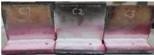
Gambar 5. Hasil Pengelasan sample C1, C2,C3 dengan Uji Pentrant Sumber: Peneliti (2021)
