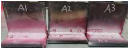
Gambar 3. Hasil Pengelasan sample A1, A2,A3 dengan Uji Pentrant Sumber: Peneliti (2021)
