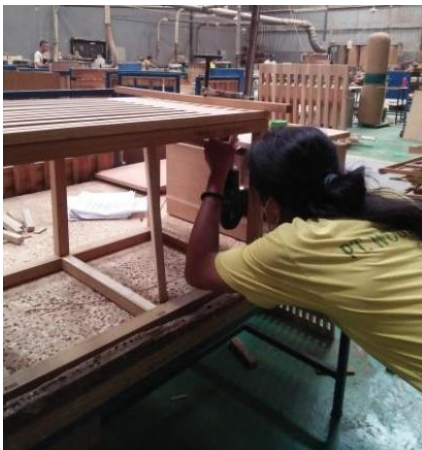
Gambar 9. Proses perakitan dinding samping ke rangka utama.
