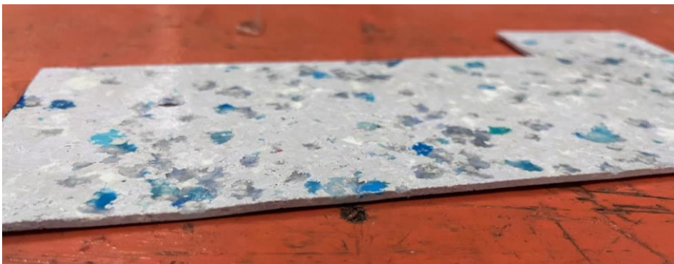
Gambar 9. Material daur ulang limbah banner PVC yang dicacah dan dipadukan dengan cacahan limbah HDPE.
