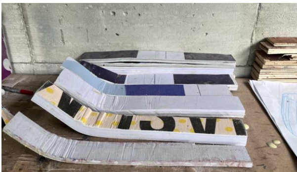
Gambar 18. Hasil pelengkungan dengan pemanas dan tanpa pemanas. (Sumber: Dokumen Pribadi)
