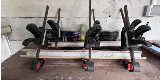
Gambar 16. Proses penggabungan masing-masing multiflex. (Sumber: Dokumen Pribadi)
