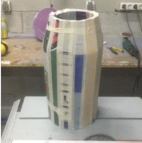
Gambar 19. Proses simulasi perakitan dengan menggunakan lakban kertas. (Sumber: Dokumen Pribadi)
