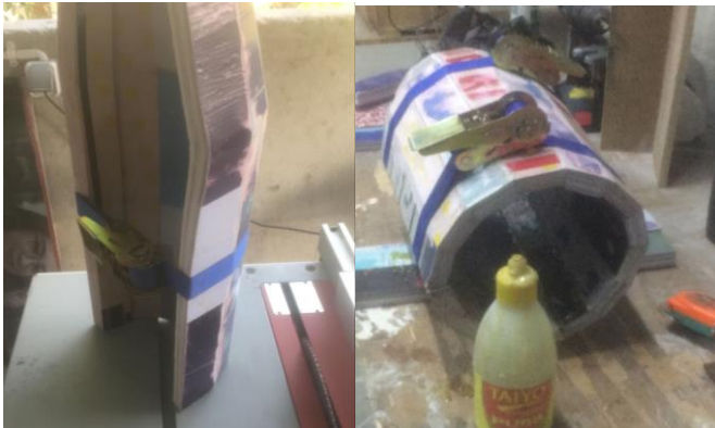
Gambar 20. Proses perekatan klowongan menggunakan lem PU. (Sumber: Dokumen Pribadi)
