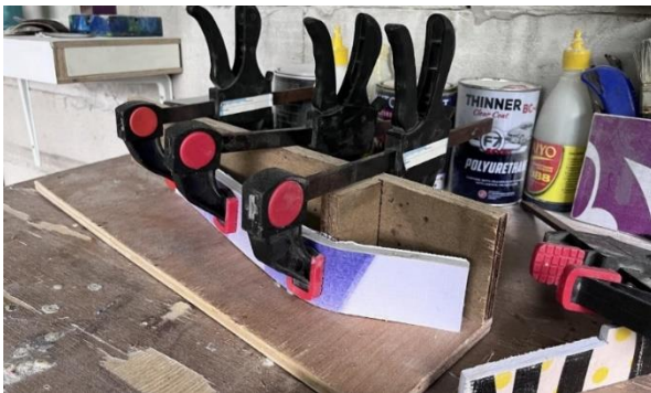
Gambar 17. Proses pelengkungan dengan jig baik dengan pemanas atau tidak. (Sumber: Dokumen Pribadi)
