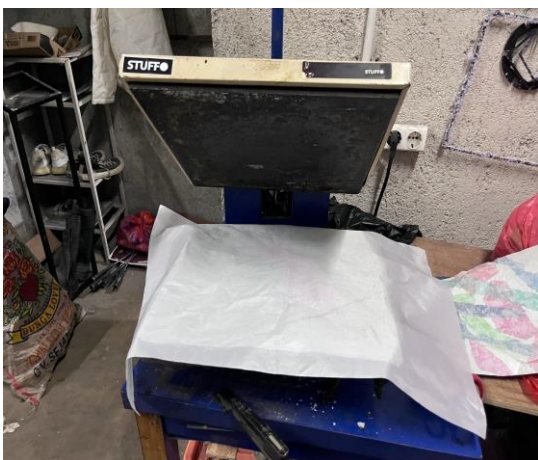
Gambar 13. Proses pemanasan limbah kantong kresek untuk membran. (Sumber: Dokumen Pribadi)
