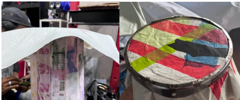
Gambar 22. Proses perakitan membran pada klowongan. (Sumber: Dokumen Pribadi)
