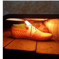
Proses oven pada sepatu untuk pengeringan lem
