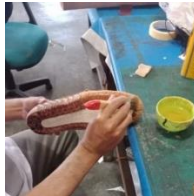
Proses pengeleman pada bawah sepatu sebelum pemasangan sol
