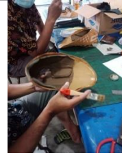
Proses pemasangan pengeras sepatu, dan pengeleman bagian ujung sepatu sebelum menjalani proses assembling (pemasangan upper pada shoelas)
