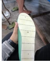
Proses pemasangan inshol pada shoelas
