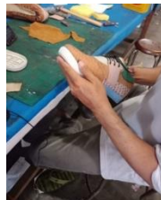
Proses pemasangan Out sol
