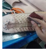
Proses pengamplasan pada bawah sepatu yang akan di letakkan /ditempel ke sol
