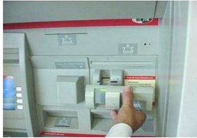
Gambar 1. Proses Pemasangan *Skimmer*
