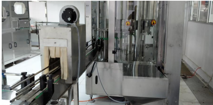
Gambar 4. Mesin Pemilah Kualitas Air Minum dalam Kemasan Botol 600mL di WTP PNJ
