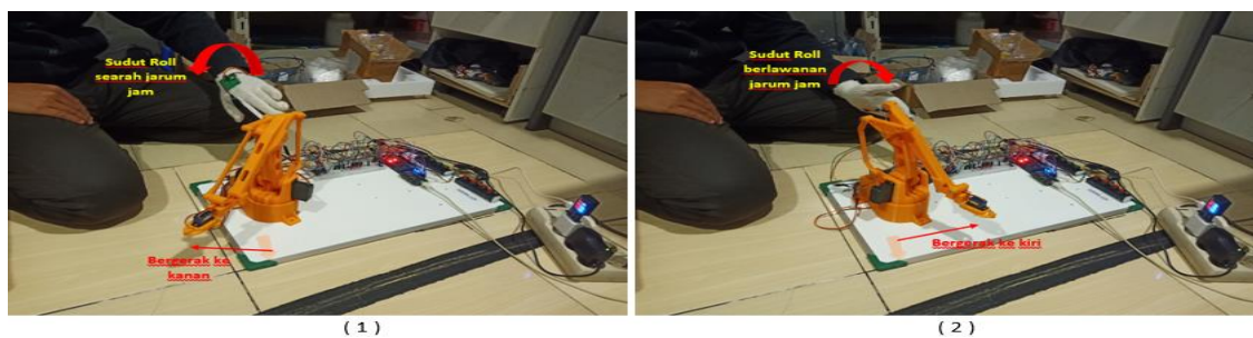
Gambar 11. Pengujian sudut roll robot gesture mode
