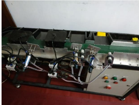
Gambar 4. Mesin Pemilah Kualitas Telur Bebek Berbasis Image Processing Tampak Atas
