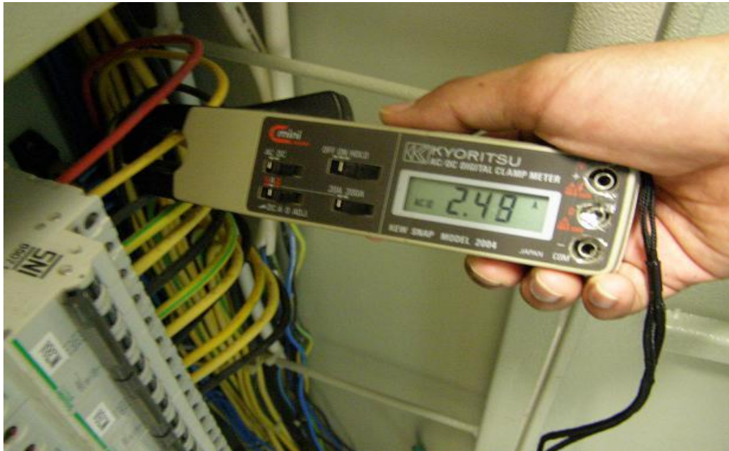
Gambar. 1. Contoh Pengambilan data listrik dalam satuan Ampere ( A )
