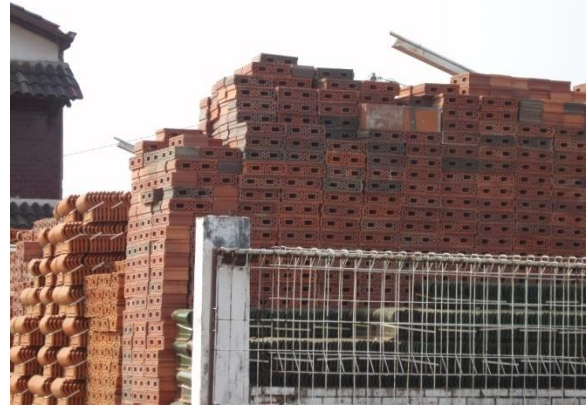
Batang keramik yang dapat dirakit menjadi gelagar keramik yang disusun menjadi balok-balok panjang pada plat lantai.
