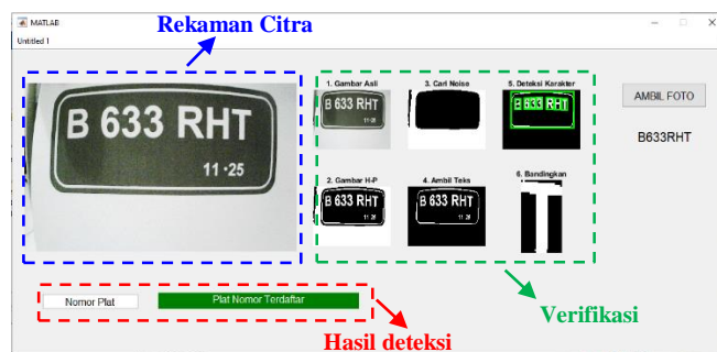
Gambar 5. Tampilan prototipe modul sistem kendali pintu gerbang otomatis berbasis pengolahan citra
