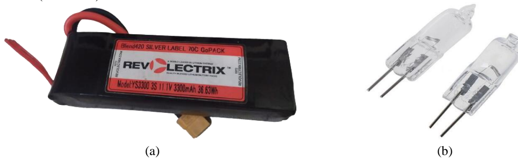
Gambar 2. (a) Baterai Lithium Polymer dan (b) Lampu pembebanan
